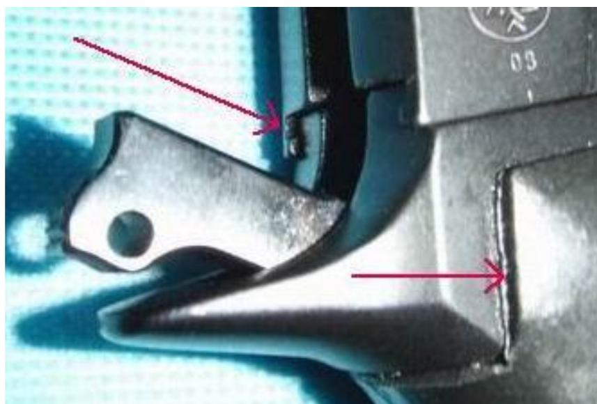
Патронник не имеет нужной глубины – затвор не доходит до крайнего переднего положения. Отсутствует обработка кромок накладки рукоятки.
