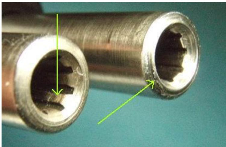
Слева – видны следы сверления на кромках нарезов.
